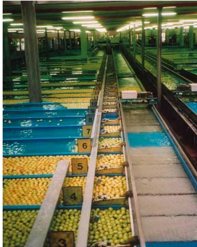
*Beeindruckend ist der Blick auf Wasserkanäle, in denen die Äpfel gewaschen und dann nach Größe und Farbe sortiert werden*
